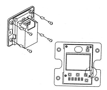
Если один внутренний блок управляется двумя пультами дистанционного управления, один из них должен быть определен главным (М), а второй - второстепенным (S). Соответствующие положения переключателя показаны ниже.
